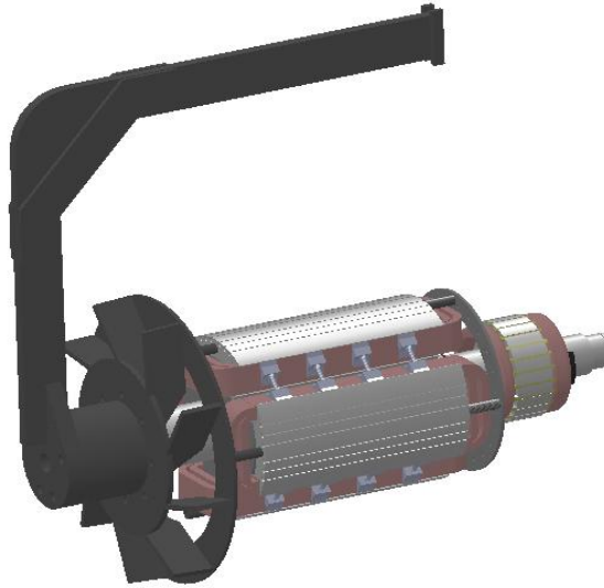
图 12 用专用转子吊具吊装转子方法
